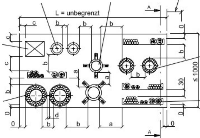
Mit FEF-Isolierungen (Synthese-Kautschuk) versehene Rohre nach Abschnitt 2.3.5 und Anlage 3 (siehe Anlage 17)
