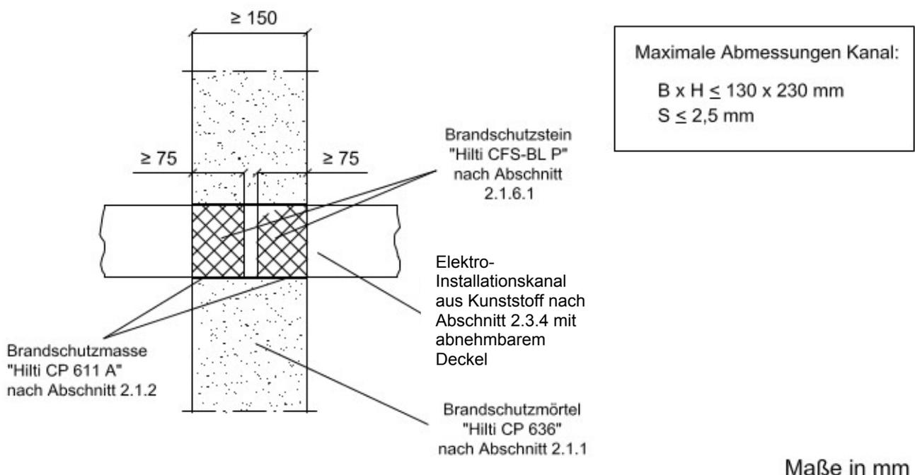
Feuerwiderstandsfähige Abschottung für elektrische Leitungen und/oder Rohrleitungen aus Kunststoff oder Metall "Hilti Brandschutz-System CP 636 - Kombi S 90"
