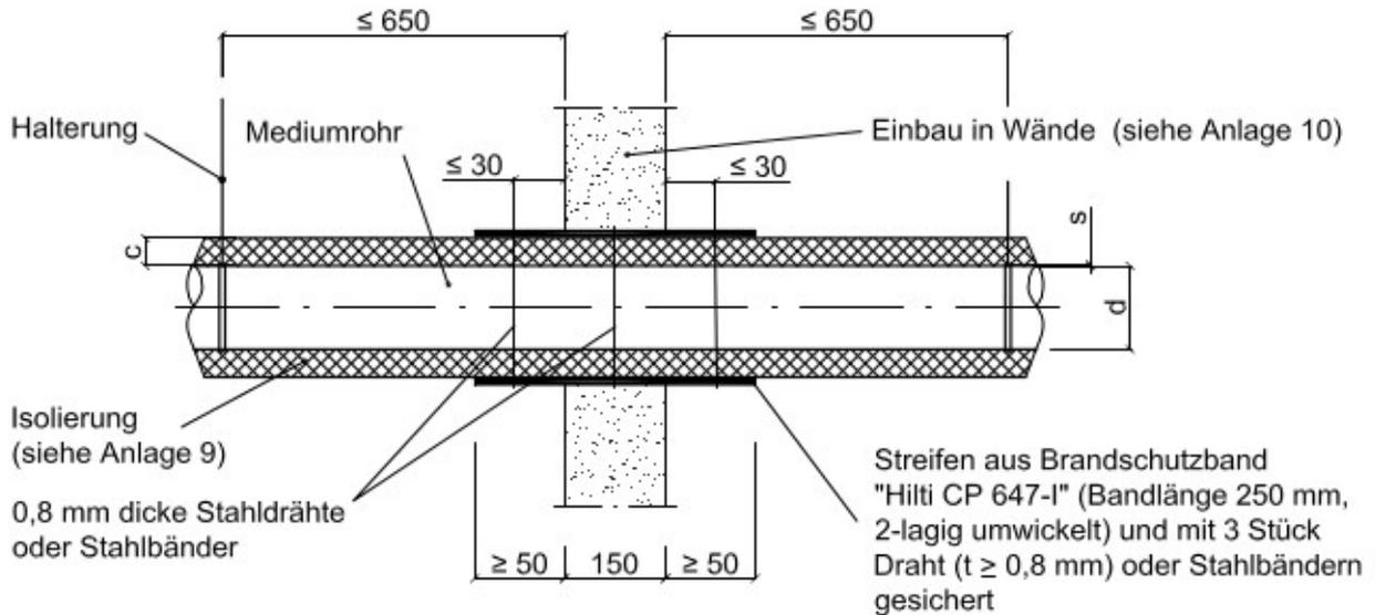
Einbau bei Schottstärke  $d > 150$  mm:
