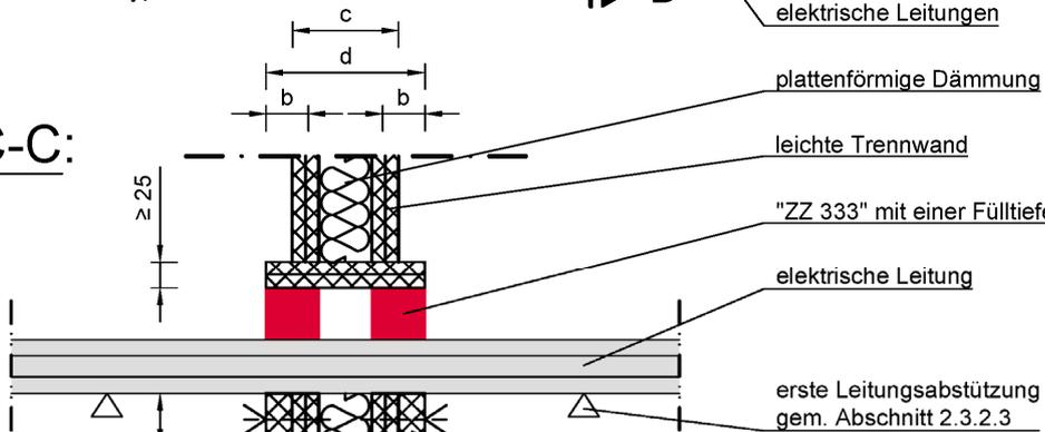
Rahmen gem. Abschnitt 2.5.2.2, alternativ Aufleistung gem. Abschnitt 2.5.2.3 und bei leichten Trennwänden ggfs. Ausstopfung mit Mineralwolle gem. Abschnitt 2.2.3 bei einer Wanddicke  $c < 200$  mm (siehe Anlage 1)
